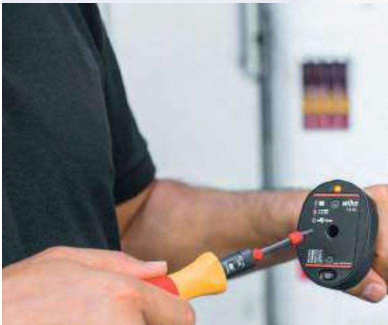
Przenośny tester narzędzi dynamometrycznych
