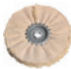
WALEC LISTKOWY FILCOWY Do polerowania i polerowania wstępnego stali nierdzewnej. Dzięki listkom filc nie „pali się”, co umożliwia polerowanie bez smug. Stosować wyłącznie w połączeniu z pastą polerską (polerowanie wstępne = pasta do polerowania wstępnego, polerowanie na wysoki połysk = pasta nabłyszczająca).
