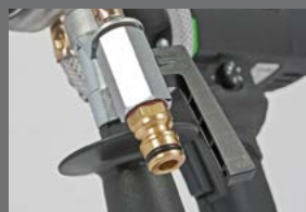
Kontrola doprowadzenia wody
