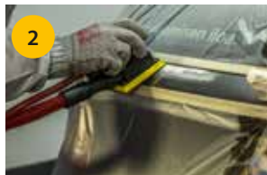
2 Wyrównanie szpachli i matowanie sąsiednich powierzchni OSP-3, OSP-4
