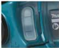
Okienko poziomu paliwa (EA3600F, EA5600F) pozwala na kontrolowanie poziomu paliwa pozostałego w zbiorniku bez konieczności jego otwierania
