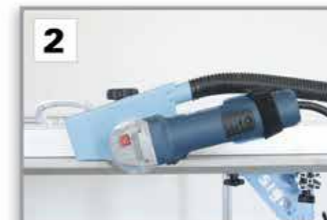
KERA-FLEX zamontowana na prowadnicy KERA-CUT pozwala na cięcie tarczą diamentową powierzchni o grubości od 30 mm.
