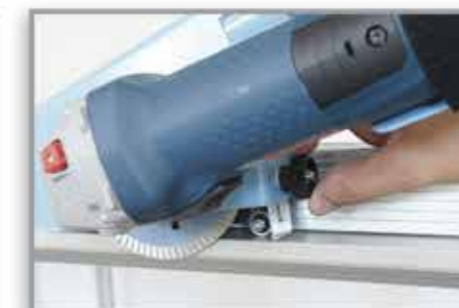
Łatwe ustawienie głębokości blokady cięcia.
