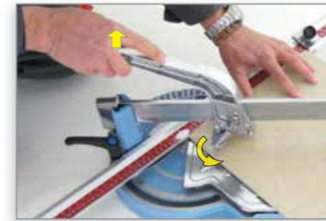
OBROTOWA STOPA DO ROZDZIELANIA CIĘTEJ PŁYTKI
