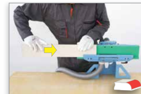
ZAOKRĄGLANIE KRAWĘDZI PŁYTEK COKOŁOWYCH
