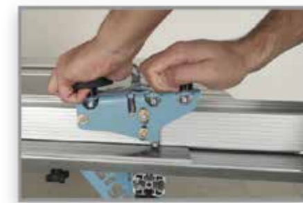
Pchnięcie oburącz wzmacnia siłę cięcia.
