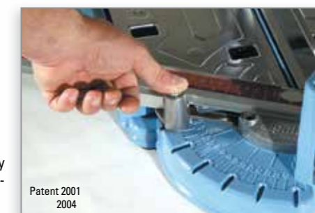
Regulowany ogranicznik umożliwiający szybkie ustawienie miarki pod najczęściej stosowanymi kątami.
