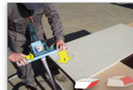
PODŁĄCZANIE ODKURZACZA I ROZPOCZĘCIE CIĘCIA.
