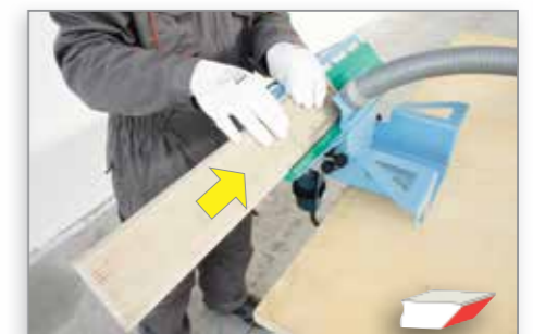
CIĘCIE PŁYTEK COKOŁOWYCH POD KĄTEM
