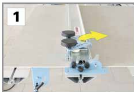
Art. 38F5 Przytwierdzenie do stołu za pomocą wsporników obrotowych do powtarzanych cięć, poprzez obracanie. Prowadnica podnosi się do wysokości 21 mm i pozwala na szybkie usunięcie płytek.
